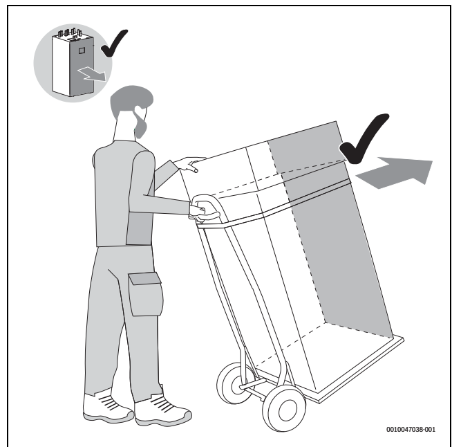
Bild 9 Inneneinheit mit einer Sackkarre transportieren
