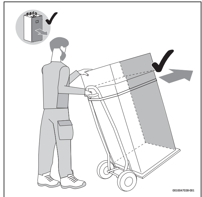
Fig. 9 Transport de l'unité intérieure avec un diable
