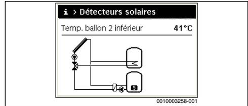
Les graphiques du menu Info représentent les pompes, le mélangeur et les vannes installés dans l'installation solaire. Si une pompe fonctionne, le symbole de la pompe tourne également. Les triangles pleins dans les symboles des mélangeurs ou des vannes représentent le sens dans lequel coule le fluide solaire.
