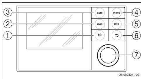
Fig. 1 Éléments de commande
