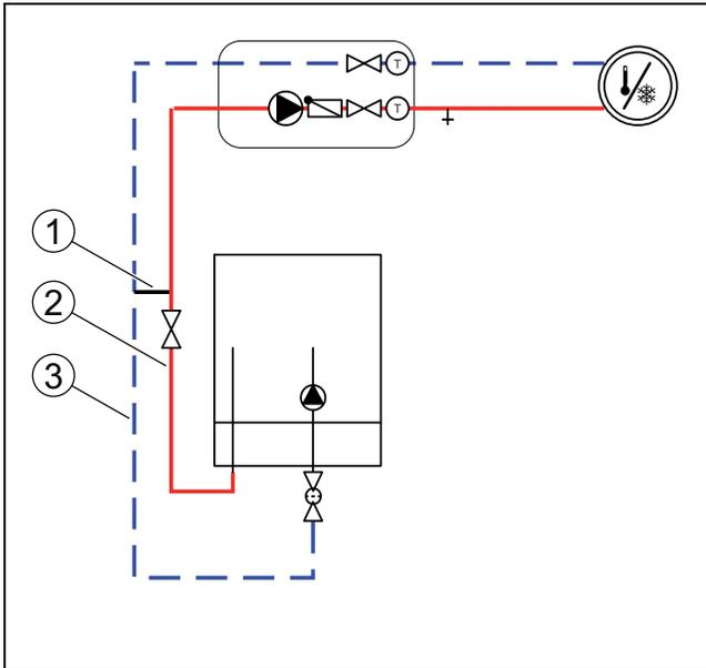
Bild 30 Inneneinheit mit Heizkreis und Bypass
