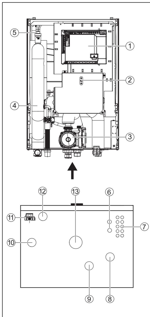
Bild 3 Bestandteile und Rohranschlüsse der Inneneinheit mit Zuheizung
