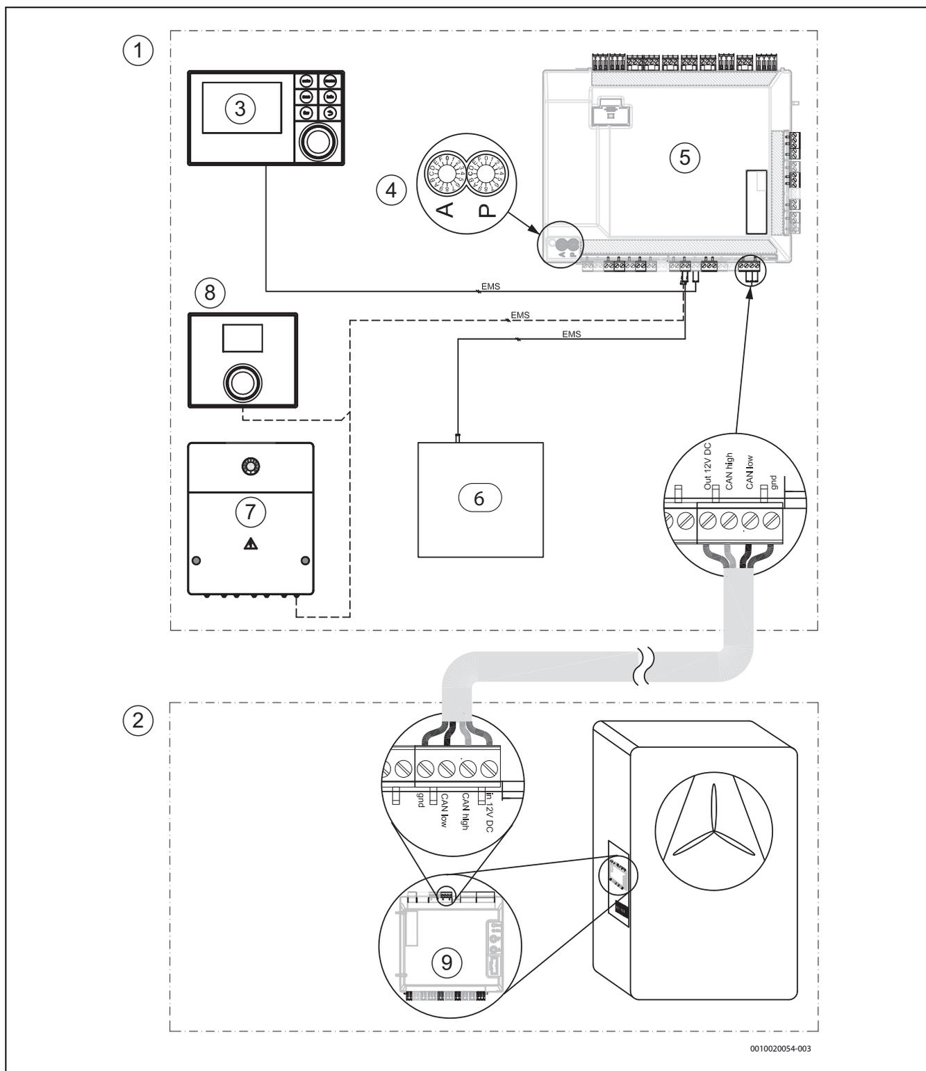
Bild 33 CAN-BUS/EMS-BUS für Inneneinheit mit elektrischem Zuheizter – Überblick
