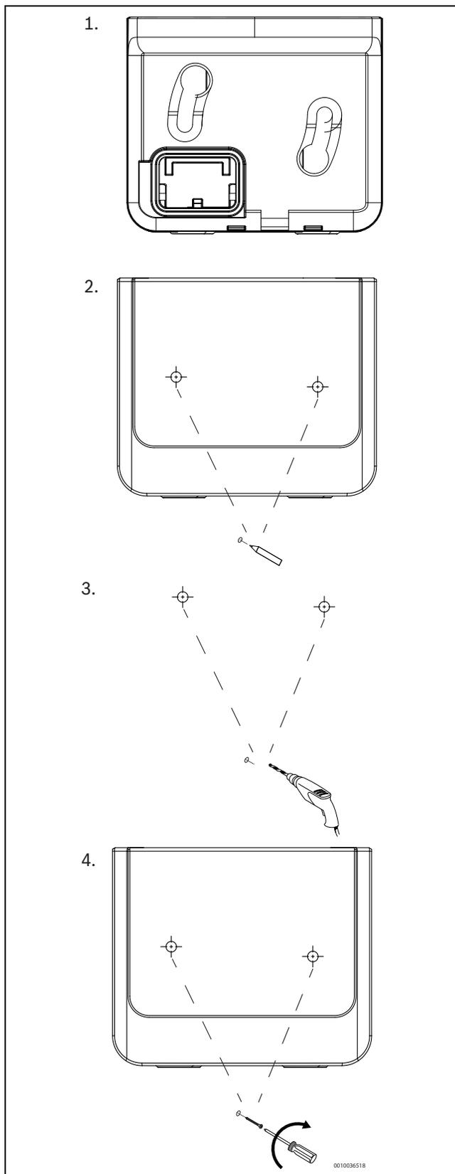
Bild 18 Montage des Halters an der Wand
