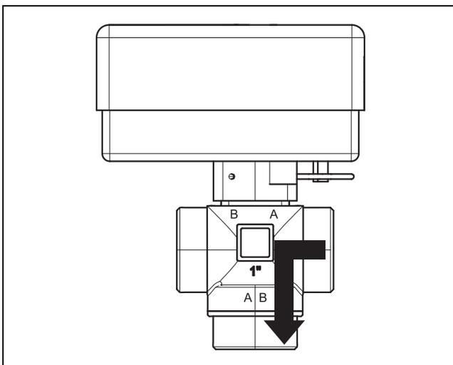
Bild 25 Kontakt geschlossen, Anschluss A offen
