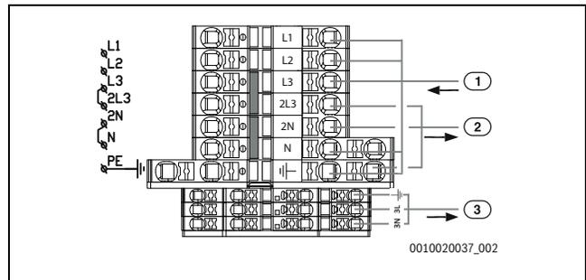
Bild 12 Elektrischer Standardanschluss bei integriertem elektrischen Zuheizter
