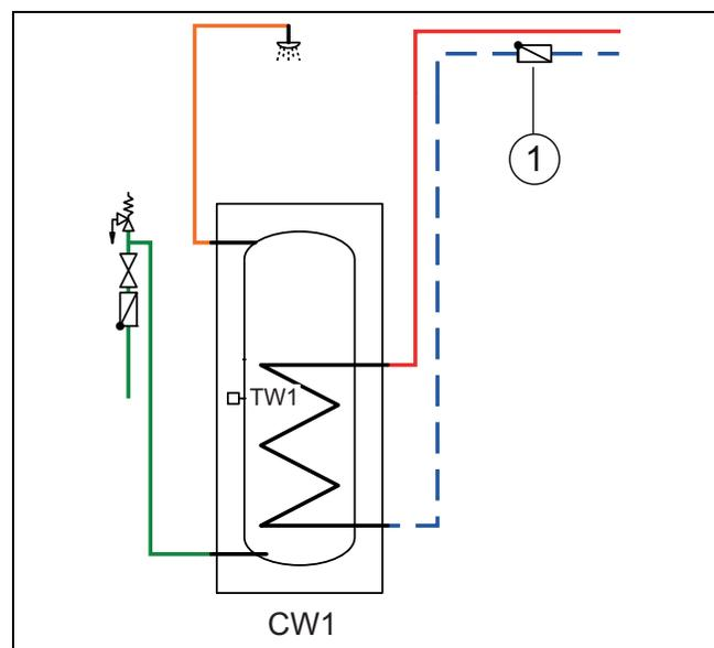
Bild 23 Warmwasserspeicher
