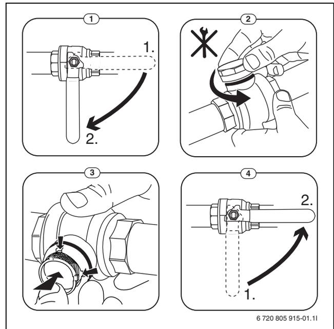
Bild 21 Siebreinigung
