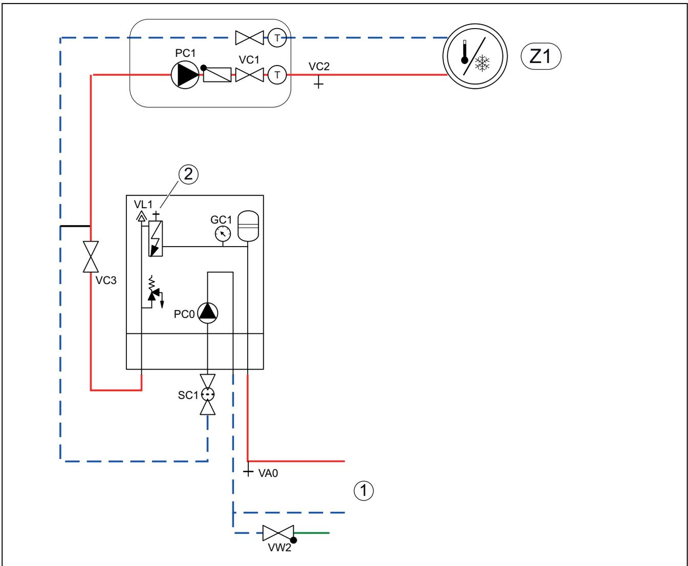
Bild 20 Inneneinheit mit integriertem elektrischem Zuheizler und Heizsystem
