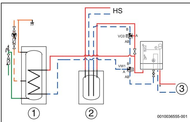
Bild 29 Puffer, VC0-Bypassventil
