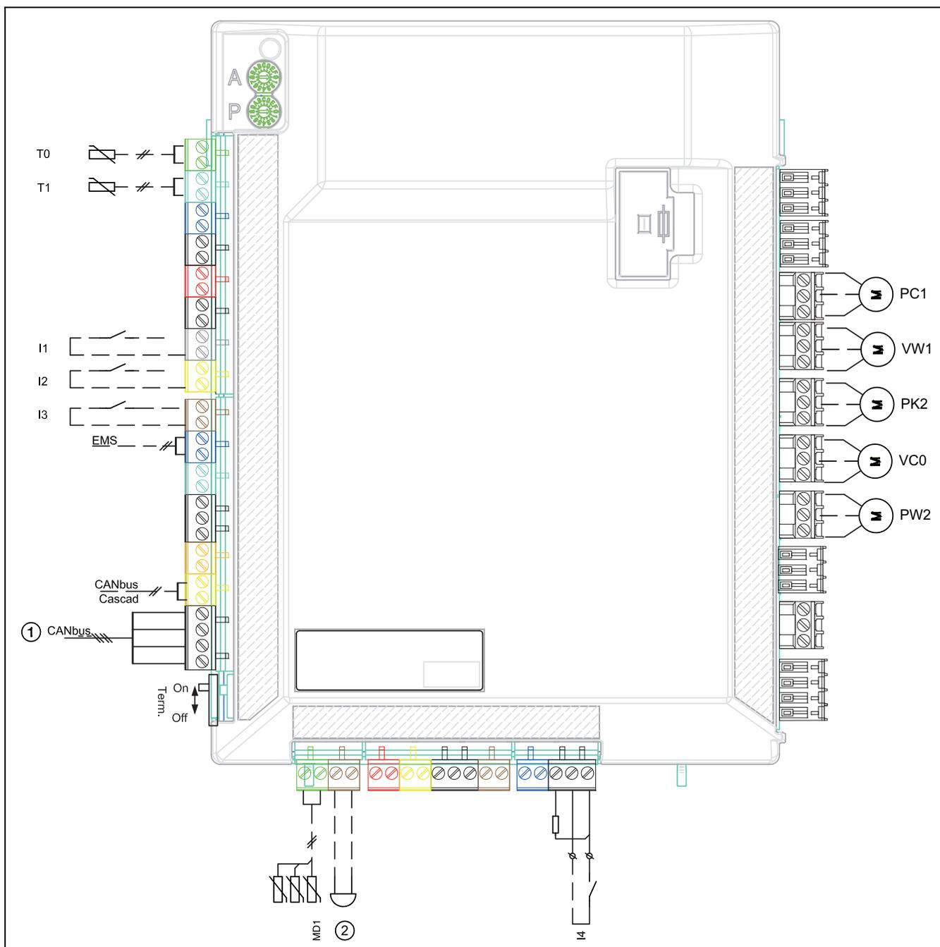
Bild 13 Anschlüsse Installationsmodul
