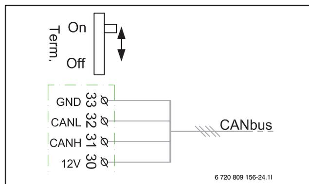
Bild 9 CAN-BUS-Terminierung
