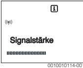
Die Funksignalstärke wird in der Segmentanzeige angezeigt. Je mehr Balken zu sehen sind, desto stärker ist das Signal.
