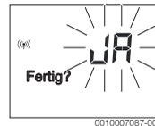
Die Konfiguration als Fernbedienung ist abgeschlossen.
