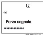
L'intensità del segnale radio viene visualizzata nell'indicazione a barre. Più barre sono visibili, maggiore è l'intensità del segnale.
