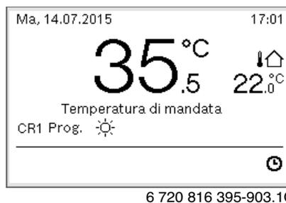
Avviene la visualizzazione di una finestra a scomparsa e il programma orario è attivato. La temperatura corrente valida lampeggia.
