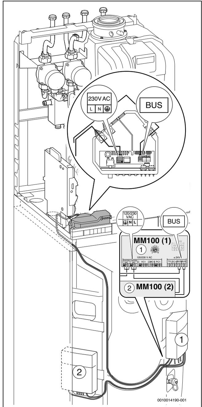
Bild 137 Anschluss MM100 (1) und MM100 (2)
