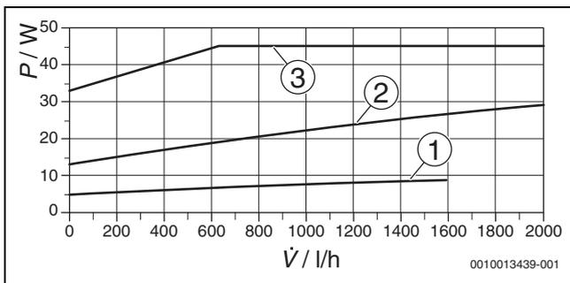
Bild 230 Leistungsaufnahme für die Pumpenstufen I bis III
