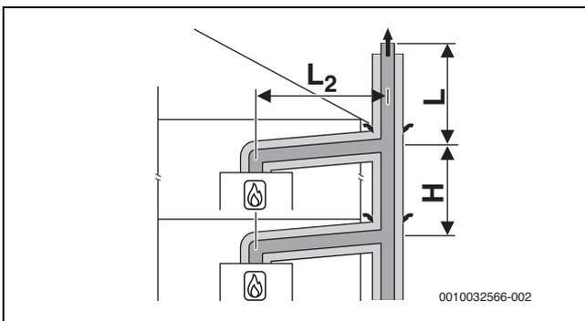
Bild 38 Mehrfachbelegung nach C<sub>(13)3x</sub> mit konzentrischer Luft-Abgas-Führung an der Außenwand und im Aufstellraum
