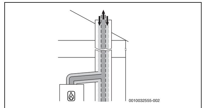
Bild 26 Konzentrische Luft-Abgas-Führung nach C<sub>43x</sub> im Aufstellraum
