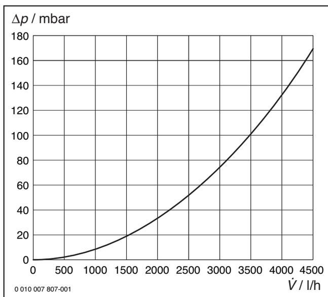
Bild 225 Druckverlust-Diagramm gemischter Heizkreis (HK2)
