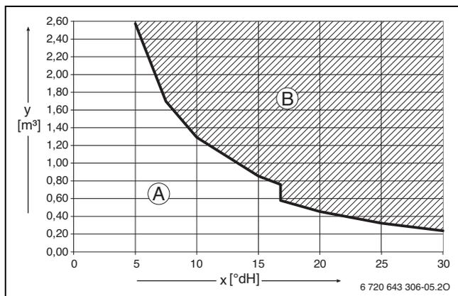
Bild 43 Anforderungen an Füll- und Ergänzungswasser Geräte < 50 kW
