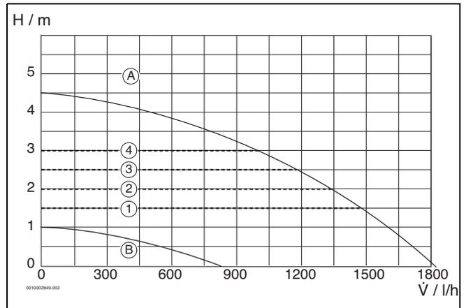
Bild 223 Pumpenkennfelder und Pumpenkennlinien
