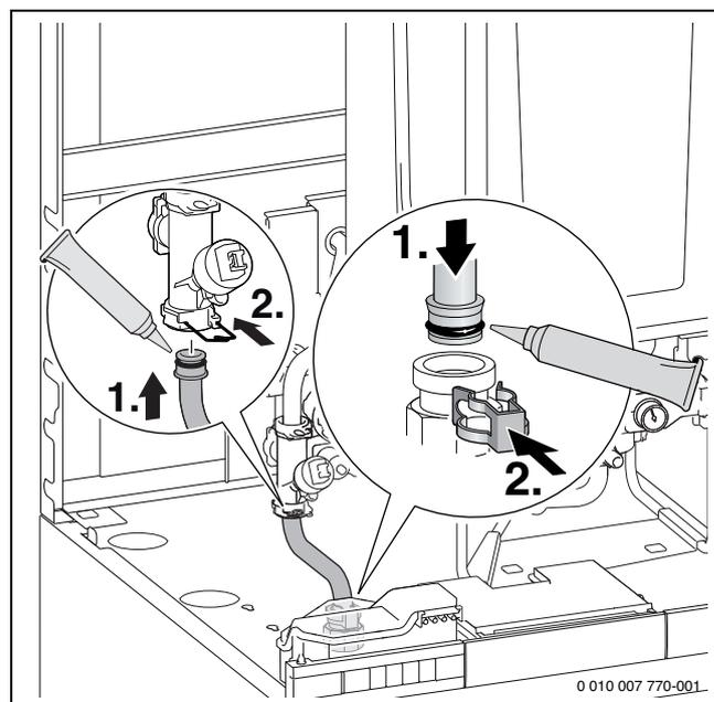
Bild 57 Rohrverbindung zwischen 3-Wege-Ventil und Speichervorlauf erstellen
