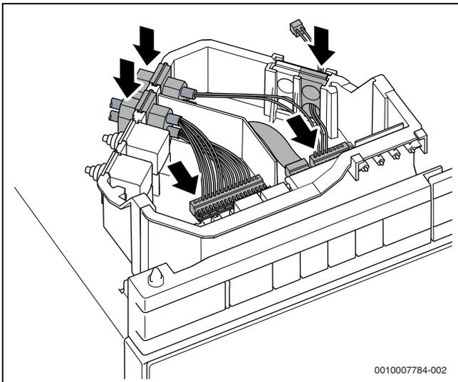
Bild 64 Steuergerät an der Anschlussbox anschließen
