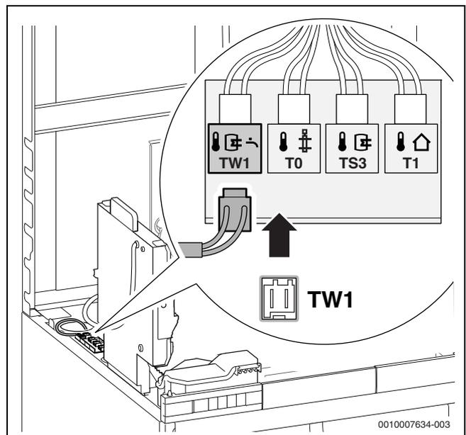
Bild 62 Speichertemperaturfühler anschließen
