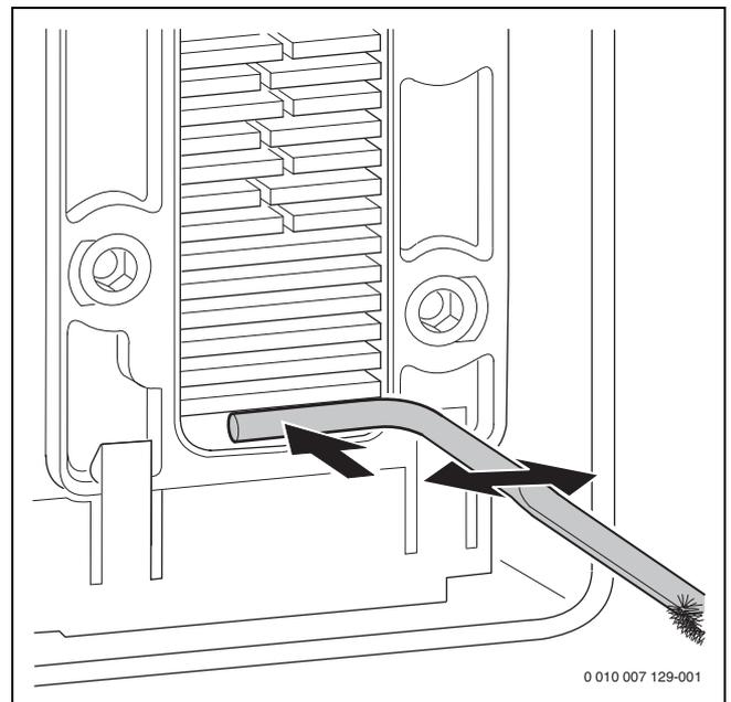
Bild 209 Kondensatwanne reinigen
