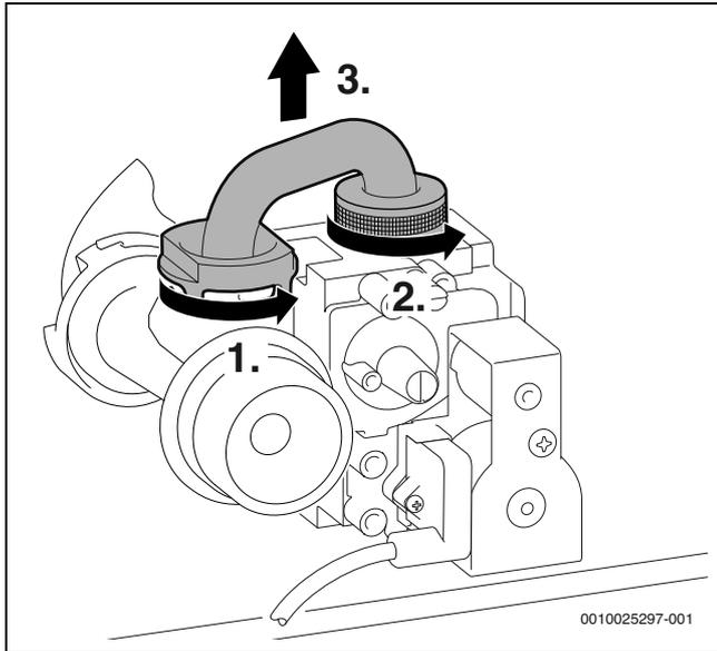
Bild 215 Gasrohr ausbauen
