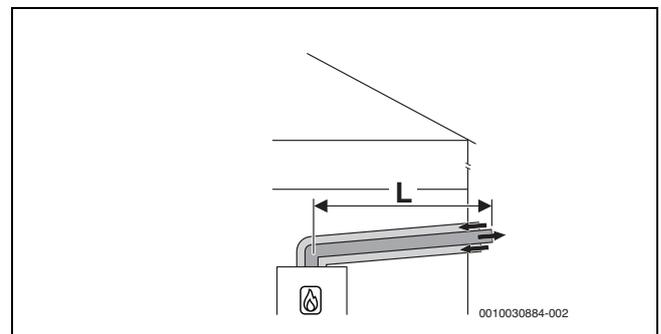
Bild 22 Horizontale konzentrische Luft-Abgas-Führung nach C<sub>13x</sub> durch die Außenwand
