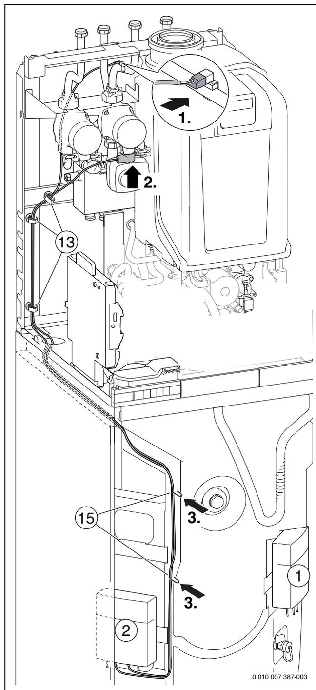
Bild 133 Anschluss Heizungspumpe gemischter Heizkreis und Temperaturfühler
