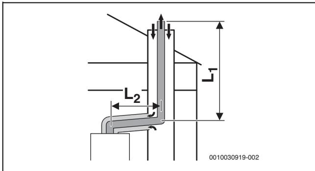
Bild 30 Starre Abgasführung nach C<sub>93x</sub> im Schacht und konzentrische Luft-Abgas-Führung im Aufstellraum
