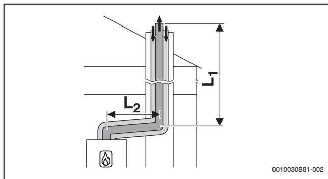
Bild 24 Konzentrische Luft-Abgas-Führung nach C<sub>33x</sub> im Schacht
