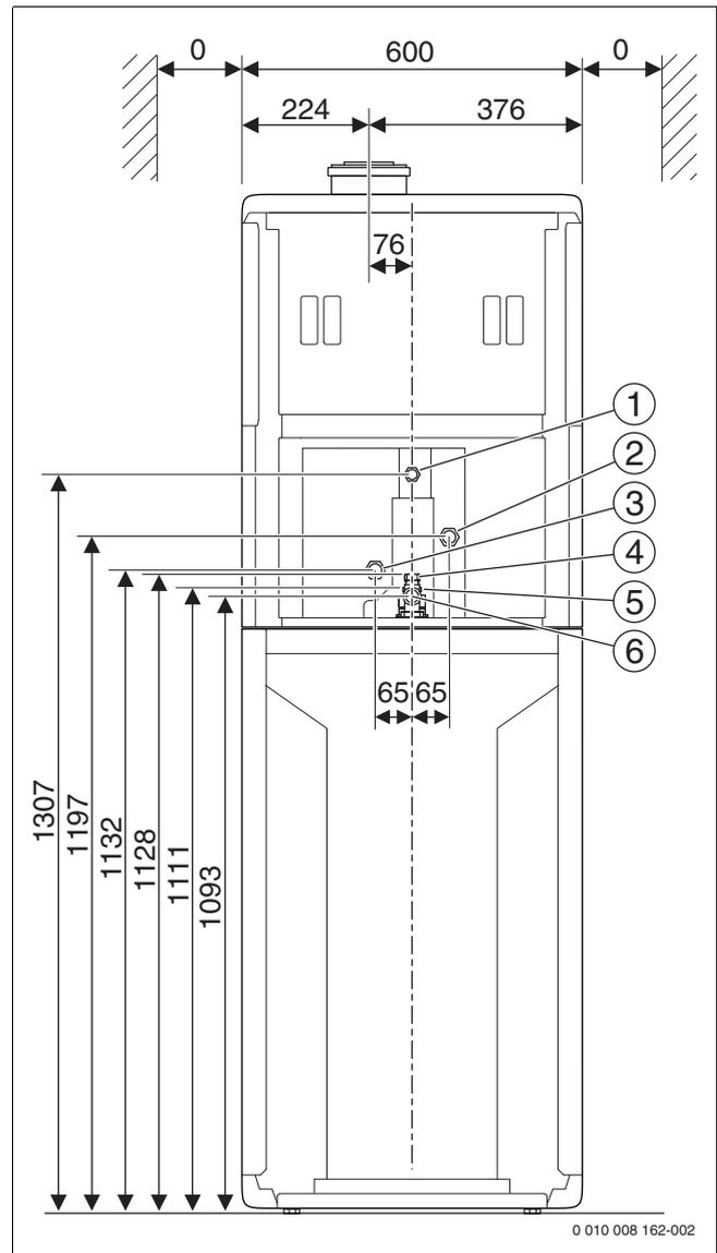
Bild 3 Abmessungen und Anschlüsse ohne Zubehör (Maße in mm)
