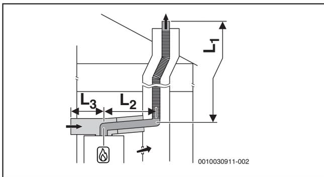
Bild 28 Flexible Abgasführung nach C<sub>53x</sub> im Schacht und Luft-Abgas-Führung mit separater Luftzufuhr und konzentrischer Abgasableitung im Aufstellraum
