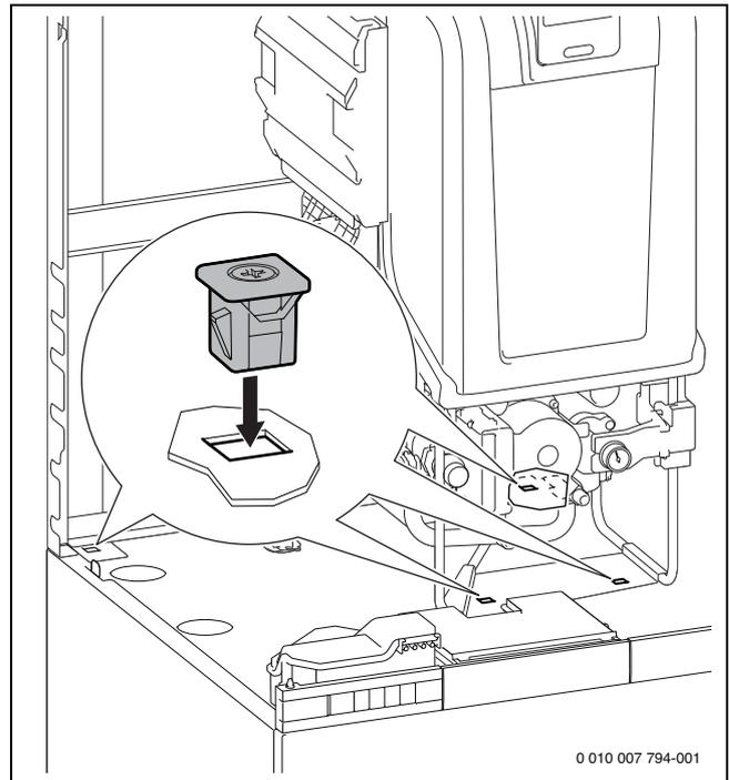
Bild 52 Gerät mit den 4 mitgelieferten Clips auf dem Speicher fixieren
