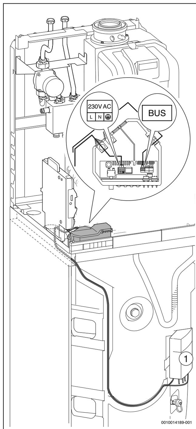
Bild 108 Anschluss Modul MM100
