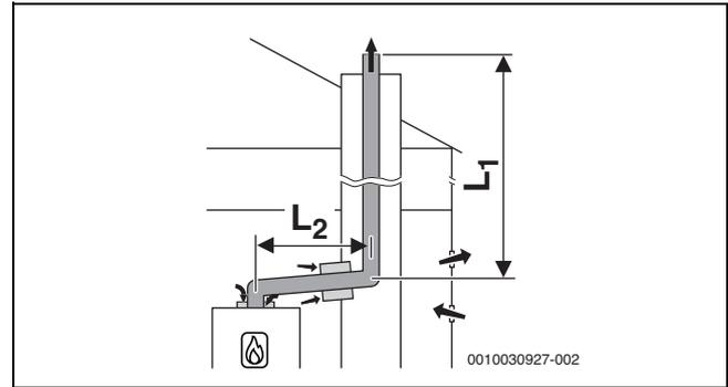
Bild 32 Starre Abgasführung im Schacht nach B<sub>23p</sub>/B<sub>53p</sub> mit raumluftabhängiger Luftzufuhr am Gerät und konzentrischem Verbindungsstück zwischen Aufstellraum und Schacht
