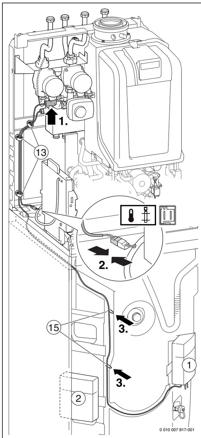
Bild 132 Anschluss Heizungspumpe ungemischter Heizkreis und Hydraulische Weiche
