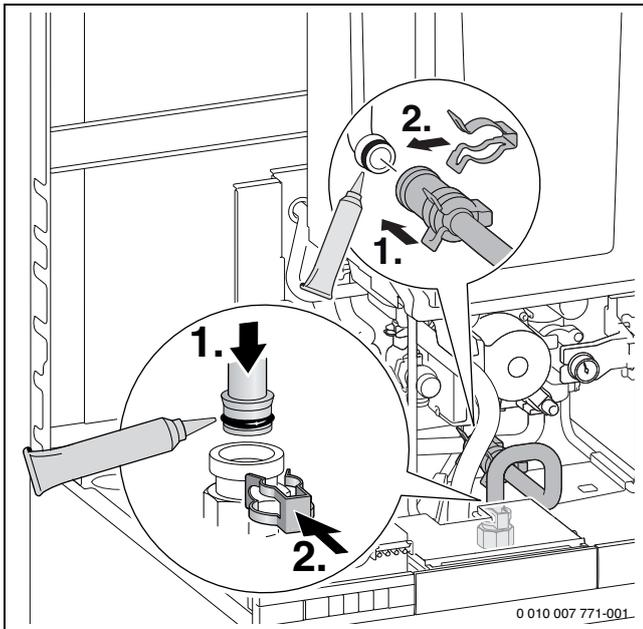
Bild 58 Rohrverbindung zwischen Speicherrücklauf und Wärmeblock erstellen
