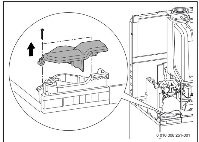
Bild 179 Abdeckung der Anschlussbox entfernen
