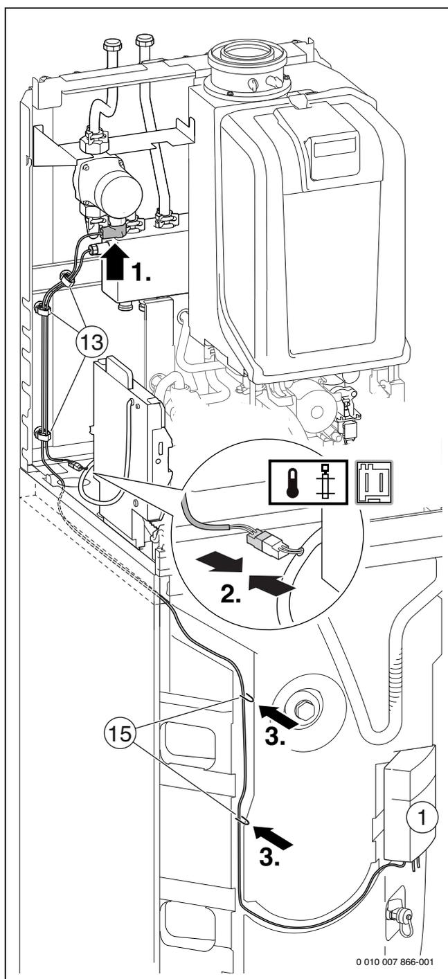
Bild 107 Anschluss Heizungspumpe ungemischter Heizkreis und Hydraulische Weiche
