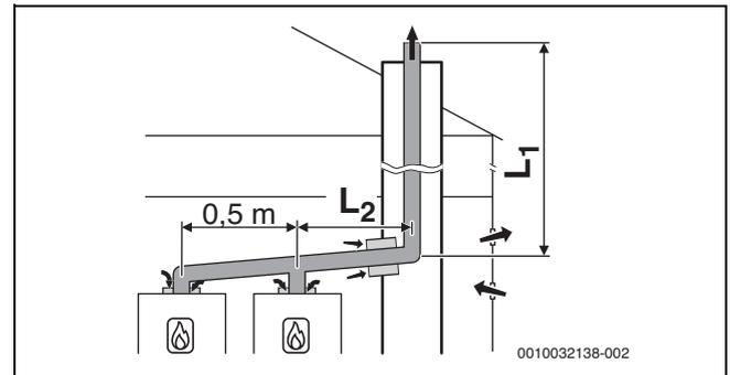
Bild 41 Kaskade mit 2 Geräten:
