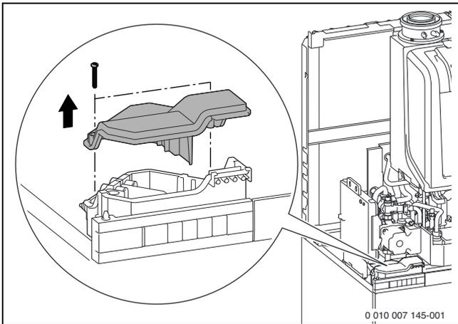
Bild 63 Abdeckung der Anschlussbox entfernen
