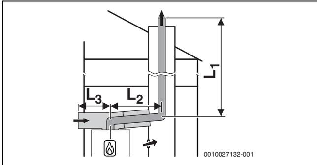
Bild 27 Starre Abgasführung nach C<sub>53x</sub> im Schacht und Luft-Abgas-Führung mit separater Luftzufuhr und konzentrischer Abgasableitung im Aufstellraum
