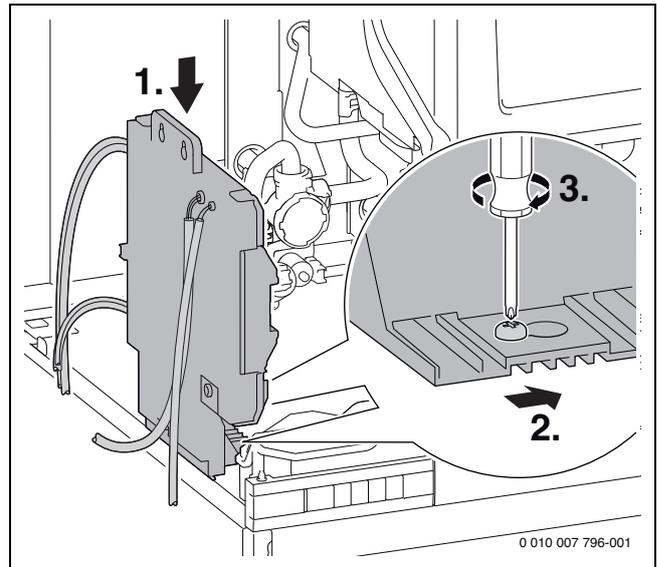
Bild 60 Steuergerät auf dem Speicher befestigen
