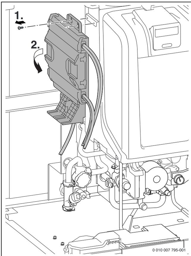
Bild 59 Steuergerät abnehmen
