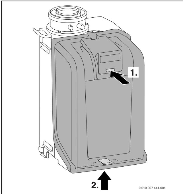
Bild 195 Brennerhaube abnehmen
