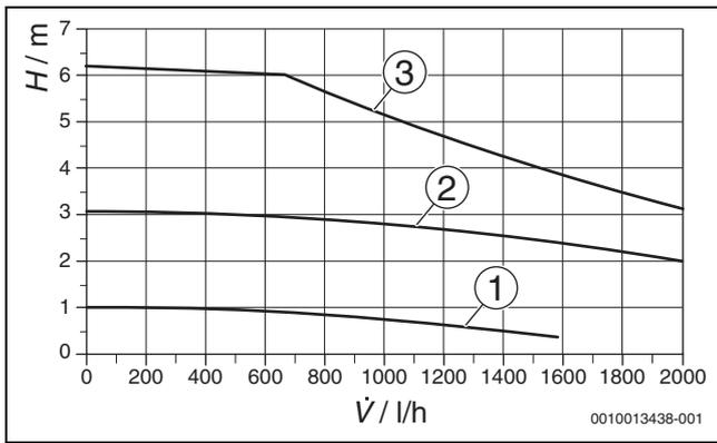
Bild 228 Pumpenkennlinien für die Pumpenstufen I bis III
