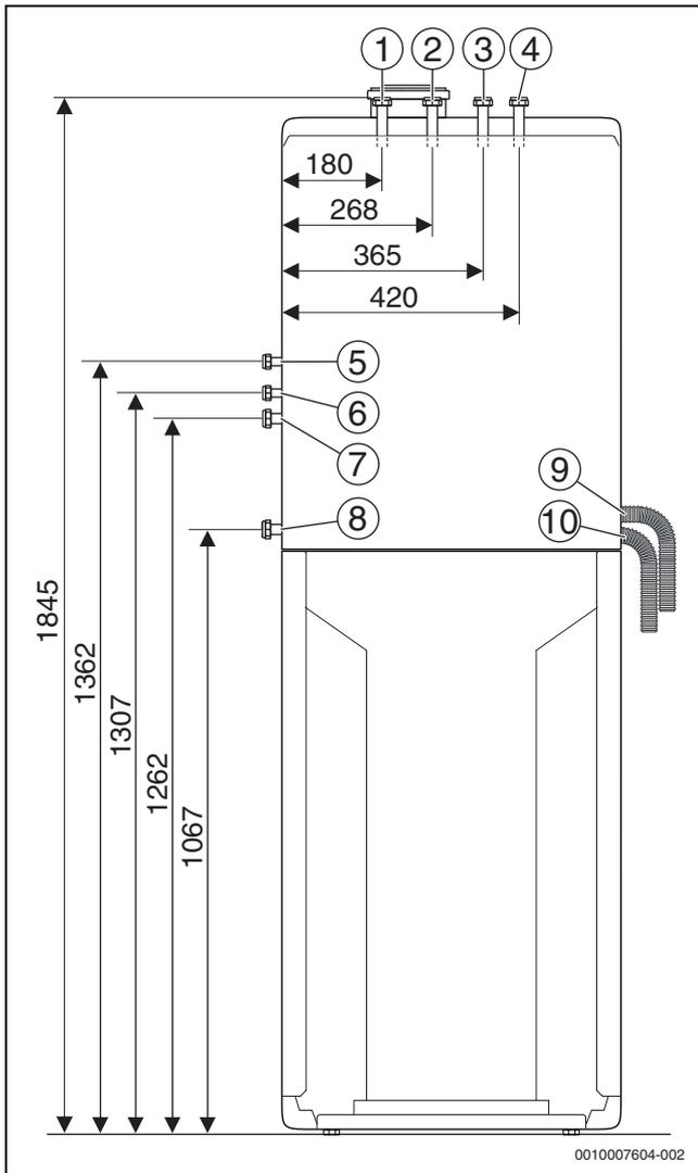
Bild 11 Anschlussmaße des Zubehörs Heizkreiserweiterung 2 (Maße in mm)
