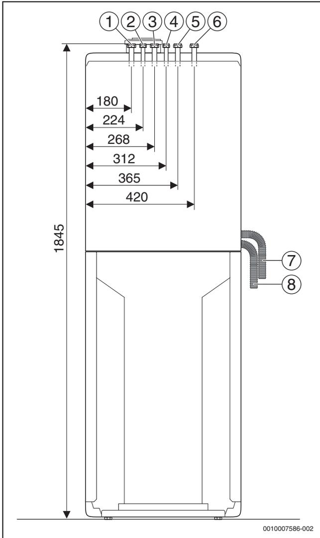
Bild 7 Anschlussmaße des Zubehörs AS-V1/Vertikales Anschluss-Set
