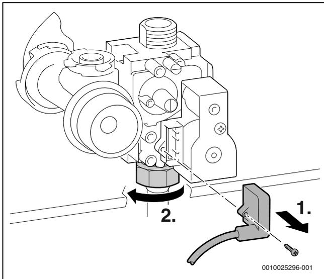
Bild 216 Stecker abziehen und Überwurfmutter lösen
