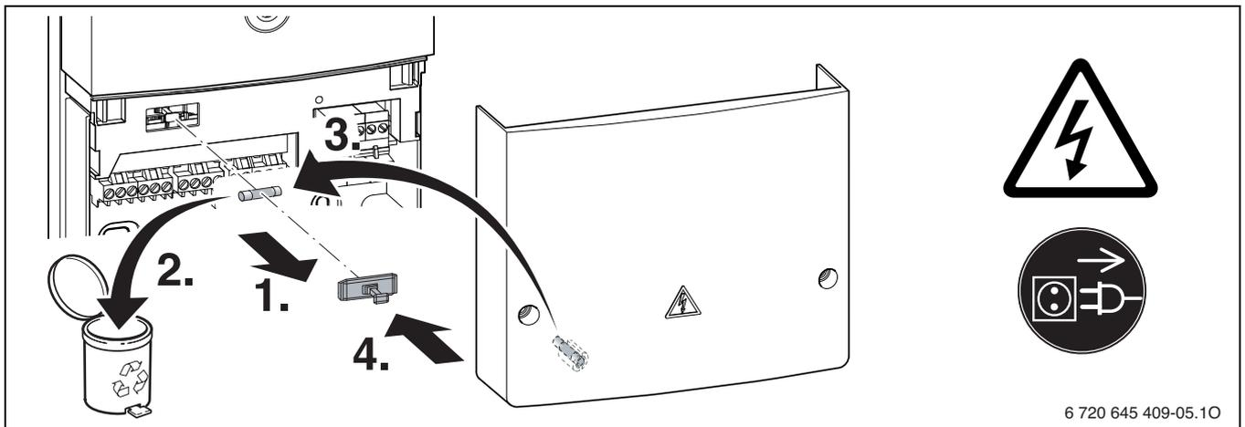
Bild 221 Sicherung vom Modul tauschen
