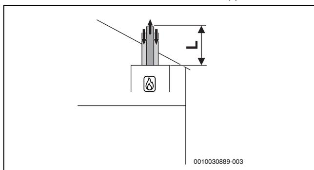
Bild 25 Vertikale konzentrische Luft-Abgas-Führung nach C<sub>33x</sub>
