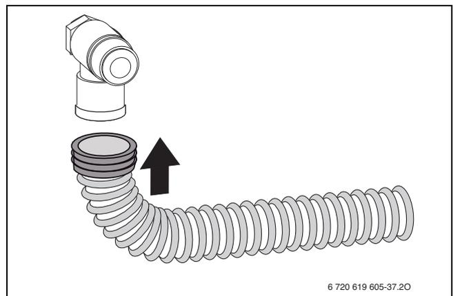
Bild 45 Schlauch am Sicherheitsventil montieren
