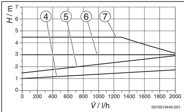
Bild 229 Pumpenkennlinien für Proportionaldruck und Konstantdruck
