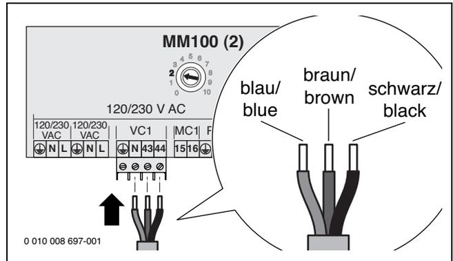
Bild 136 Anschluss Kabel Mischermotor am Modul MM100 [2]
