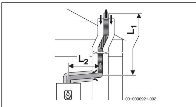
Bild 31 Flexible Abgasführung nach C<sub>93x</sub> im Schacht und konzentrische Luft-Abgas-Führung im Aufstellraum
