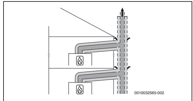
Bild 37 Mehrfachbelegung nach C<sub>(12)3x</sub> mit konzentrischer Luft-Abgas-Führung im Aufstellraum
