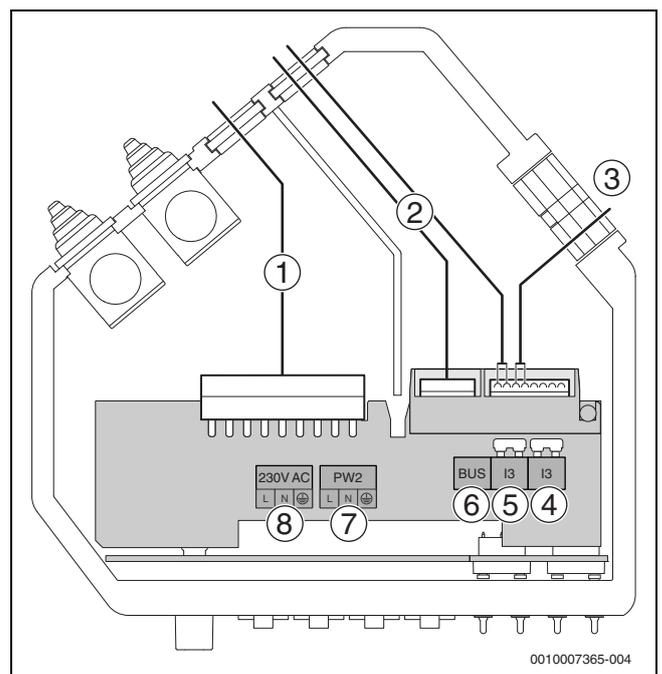
Bild 181 Anschlussbox
