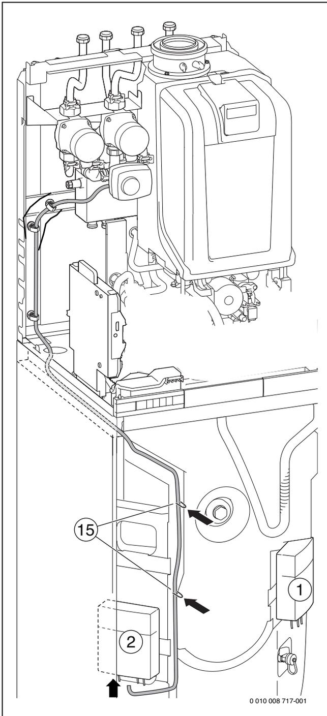
Bild 134 Anschluss Mischermotor
