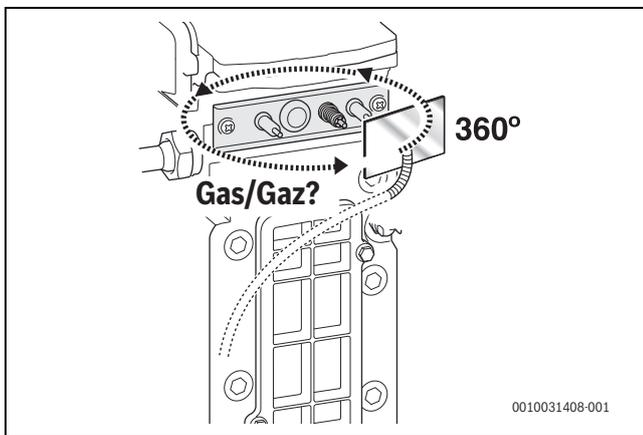
Bild 202 Dichtheit kontrollieren
