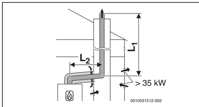
Bild 34 Starre Abgasführung im Schacht nach B<sub>33</sub> mit raumluftabhängiger Luftzufuhr über die konzentrische Luft-Abgas-Führung im Aufstellraum
