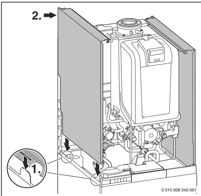
Bild 187 Rechte und linke Verkleidung montieren
