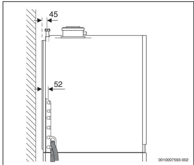
Bild 12 Anschlussmaße des Zubehörs Heizkreiserweiterung 2 (Maße in mm)
