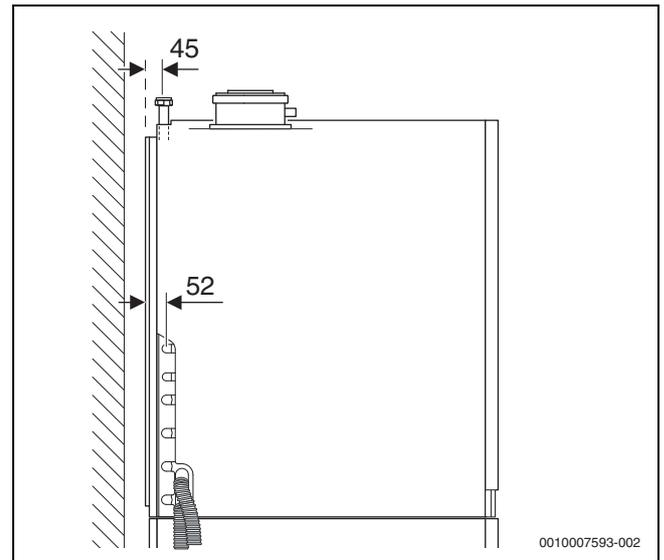
Bild 10 Anschlussmaße des Zubehörs Heizkreiserweiterung 1 (Maße in mm)
