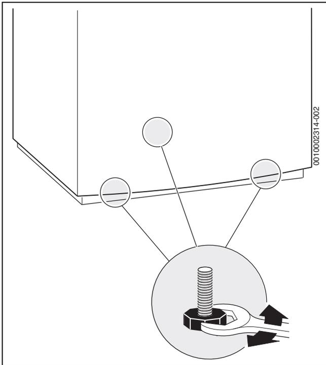
Bild 50 Speicher ausrichten
