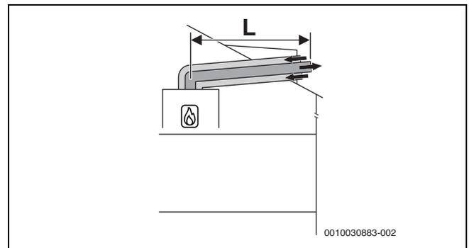
Bild 23 Horizontale konzentrische Luft-Abgas-Führung nach C<sub>13x</sub> über das Dach
