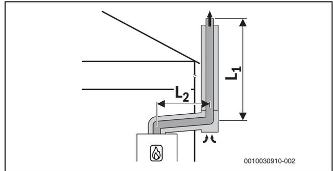
Bild 29 Konzentrische Luft-Abgas-Führung nach C<sub>53x</sub> an der Außenwand
