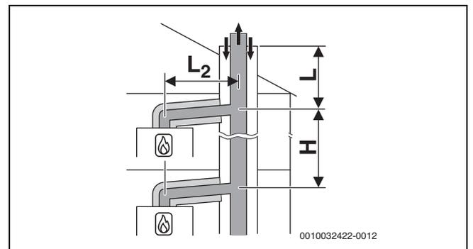
Bild 39 Mehrfachbelegung nach C<sub>(14)3x</sub> mit kollektiver starrer Abgasführung und konzentrischer Luft-Abgas-Führung im Aufstellraum
