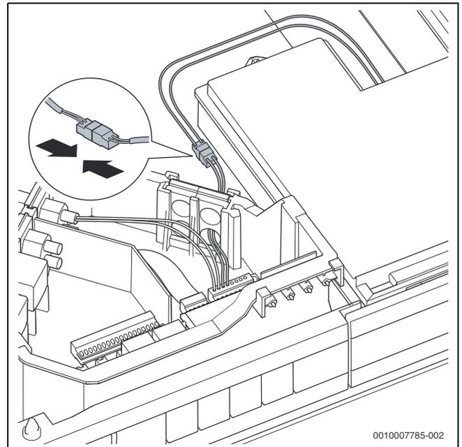
Bild 66 Schublade für den Regler an der Anschlussbox anschließen
