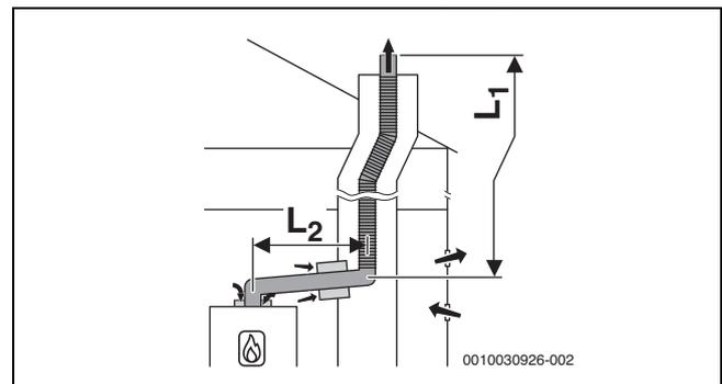
Bild 33 Flexible Abgasführung im Schacht nach B<sub>23p</sub>/B<sub>53p</sub> mit raumluftabhängiger Luftzufuhr am Gerät und konzentrischem Verbindungsstück zwischen Aufstellraum und Schacht
