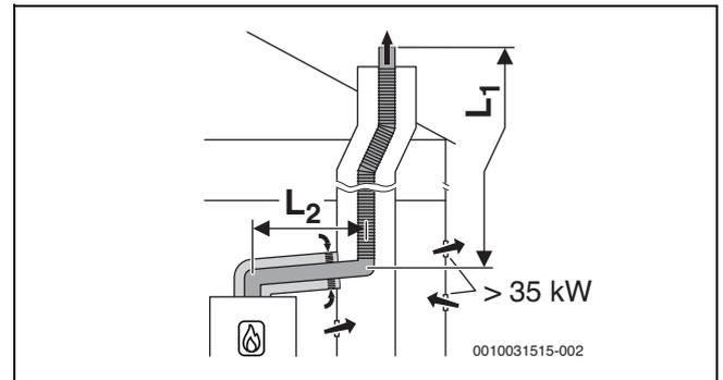
Bild 35 Flexible Abgasführung im Schacht nach B<sub>33</sub> mit raumluftabhängiger Luftzufuhr über die konzentrische Luft-Abgas-Führung im Aufstellraum
