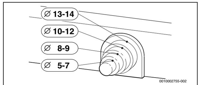
Bild 180 Zugentlastung an Kabeldurchmesser anpassen
