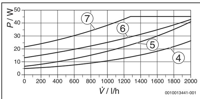
Bild 231 Leistungsaufnahme für Proportionaldruck und Konstantdruck
