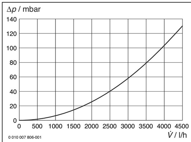
Bild 224 Druckverlust-Diagramm ungemischter Heizkreis (HK1)
