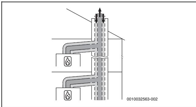
Bild 36 Mehrfachbelegung nach C<sub>(10)3x</sub> mit konzentrischer Luft-Abgas-Führung im Aufstellraum4.17.4 Luft-Abgas-Führung nach C<sub>(12)3x</sub>
