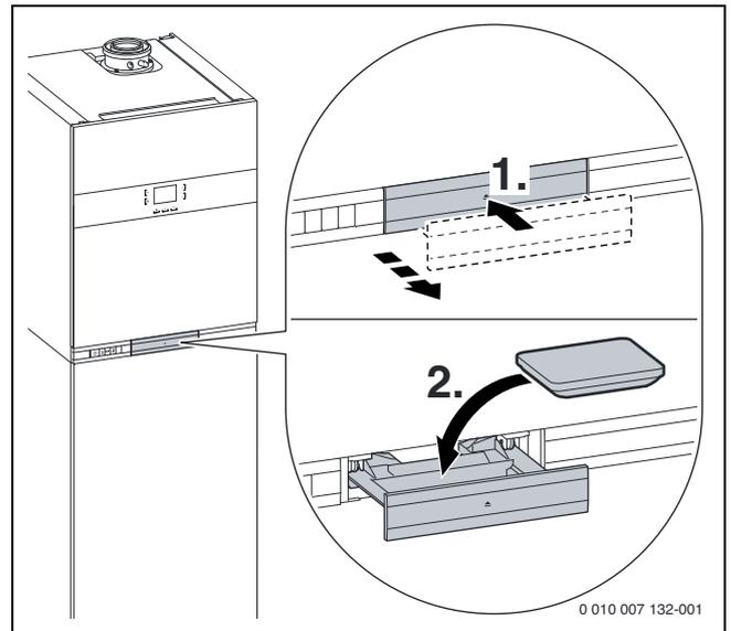
Bild 185 Heizungsregler einstecken
