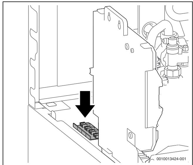
Bild 61 Steckerleiste auf dem Speicher befestigen
