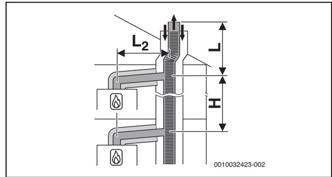
Bild 40 Mehrfachbelegung nach C<sub>(14)3x</sub> mit kollektiver flexibler Abgasableitung und konzentrischer Luft-Abgas-Führung im Aufstellraum
