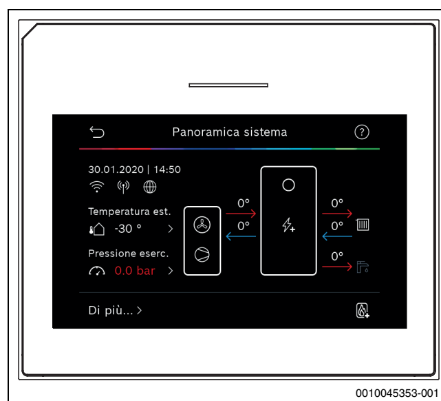
Fig. 11 Panoramica di sistema pompa di calore
