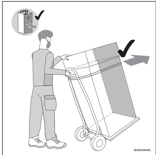
Bild 9 Inneneinheit mit einer Sackkarre transportieren
