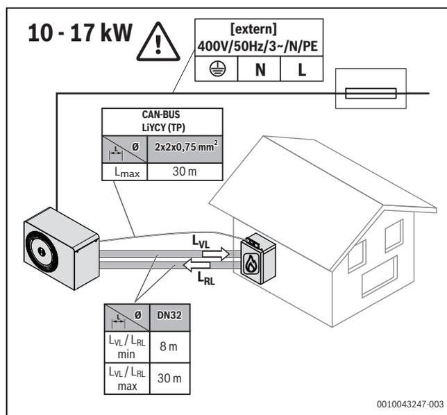
Bild 6 Anforderungen an Leitungslängen 10 – 17 kW
