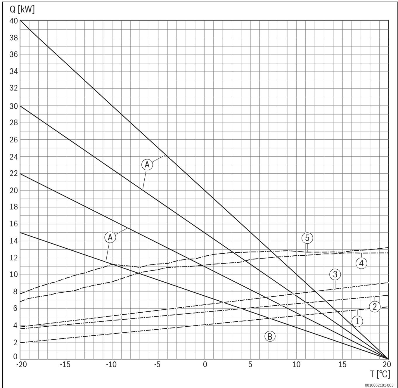
Bild 23 Diagramm zu Tab. 8; Zur Bestimmung der Bivalenzpunkte bei **55 °C** Vorlauftemperatur
