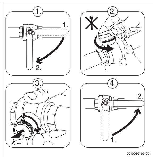
Bild 25 Aus- und Einbau des Partikelfilters (Beispiel)
