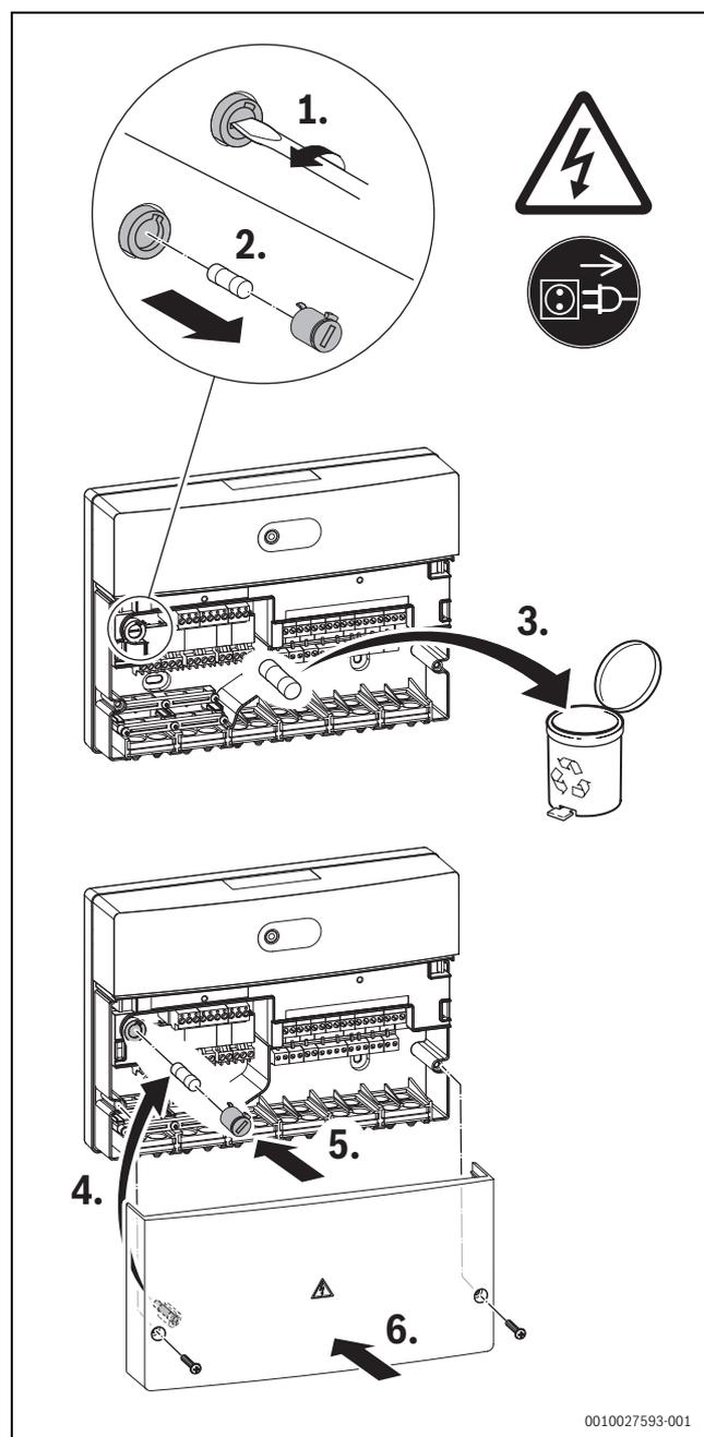
Bild 27 Sicherung tauschen
