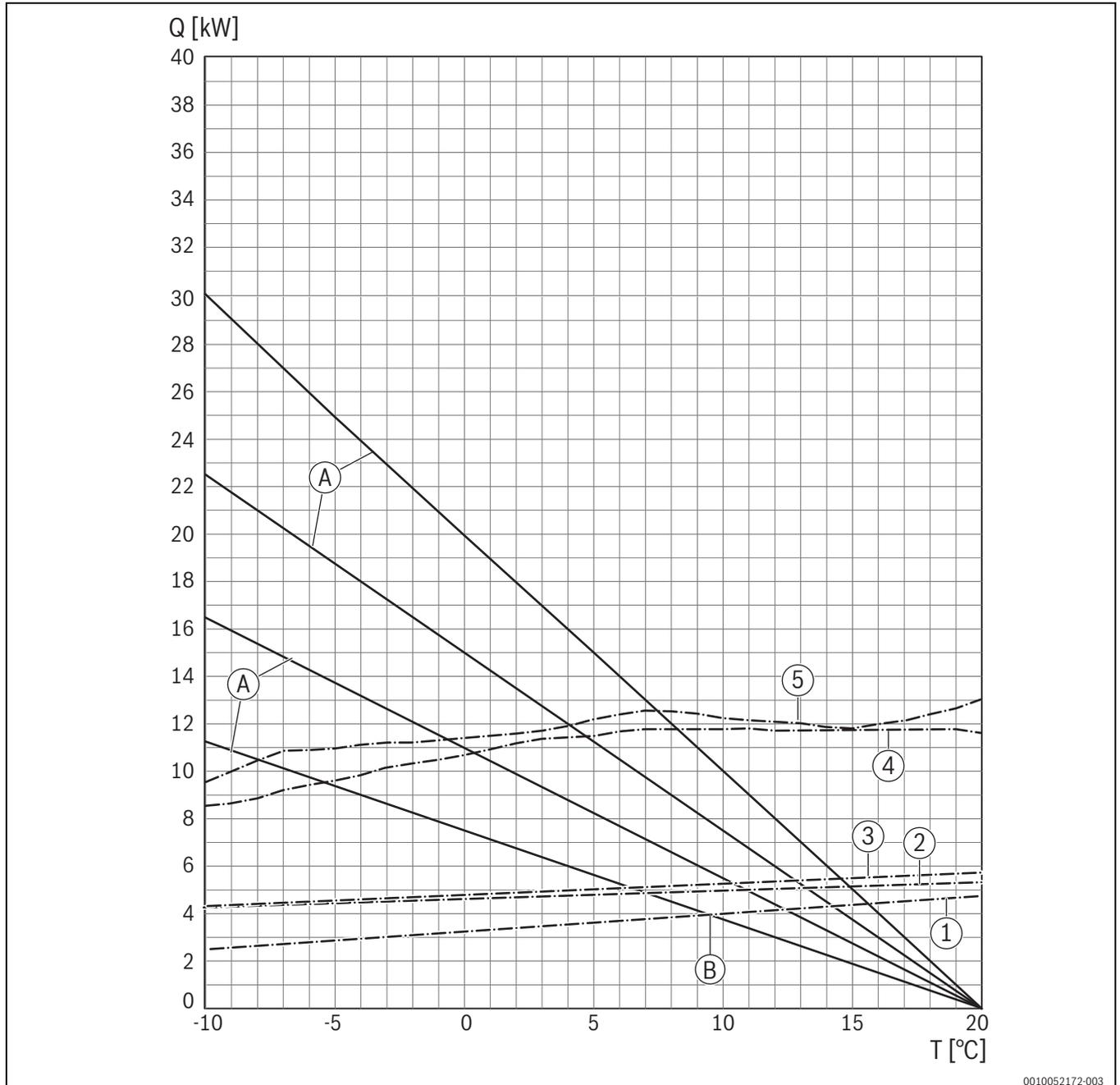
Bild 24 Diagramm zu Tab. 9; Zur Bestimmung der Bivalenzpunkte bei 65 °C Vorlauftemperatur
