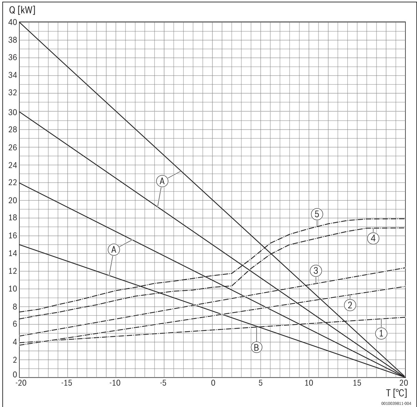
Bild 22 Diagramm zu Tab. 7; Zur Bestimmung der Bivalenzpunkte bei 55 °C Vorlauftemperatur
